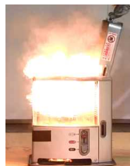
(写真) カートリッジタンクのふたが外れて灯油が高温部にかかり発火
