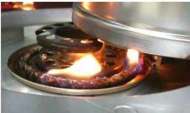
(写真) 芯が下がらず、消火不良となった芯式石油ストーブ
