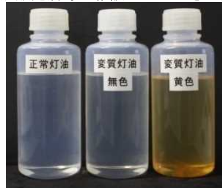
(写真) 左から新品の灯油、色の変化がない変質した灯油、変色した灯油
